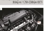
Max Power: 100ps / 6,000rpm Max Torque: 13.6kg-m / 3,500rpm
